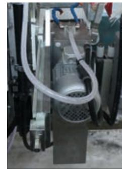
Mandrino multifunzione per levigare il risvolto o per eseguire la bocciardatura antiscivolo o per effettuare incisioni verticali ed inclinati.
