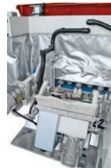
1 Calibratore / gocciolatoio e gruppo smussi / sgrassatori aperto. Calibrator / water drip unit and open beveling / roughing spindles group.
